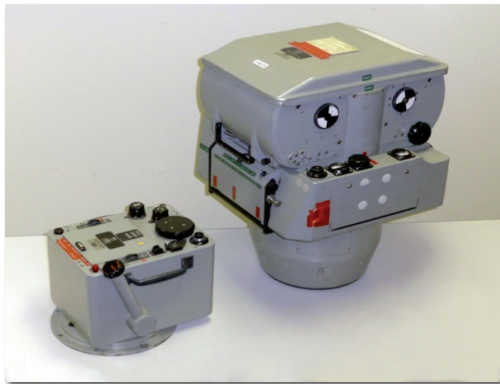
Εικόνα 12: Φωτομηχανή WILD (LEICA) RC
