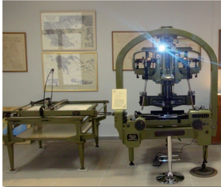
Εικόνα 19: Στερεοαναγωγικό αναλογικό όργανο WILD A5 (Μουσείο ΓΥΣ)
