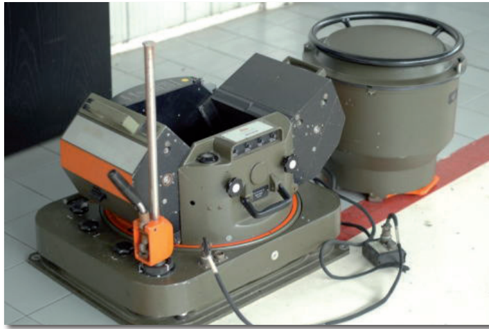
Εικόνα 12: Φωτομηχανή WILD (LEICA) RC
