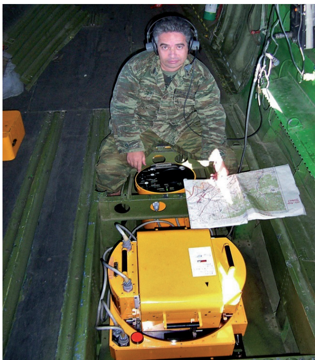
Εικόνα 14: Φωτομηχανή ZEISS LMK επί Αεροσκάφους C-47
