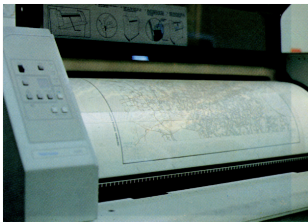
Εικόνα 30: Αυτόματος κυλινδρικός σαρωτής (δεκαετία 90)
