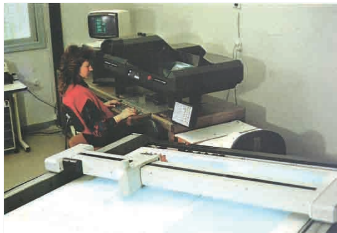
Εικόνα 21: Αναλυτικό Ηλεκτρονικό Φωτογραμμετρικό Όργανο WILD BC2
